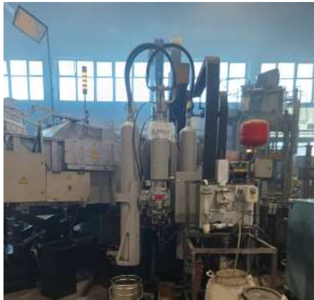
Слика 5 Изглед на ливачки остров на алуминиумски легури
